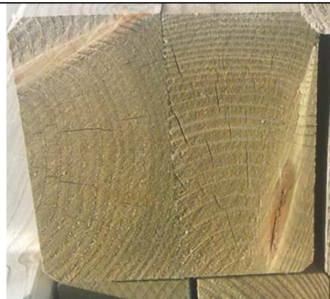
6. ábra Nem megfelelő ragasztási sík
