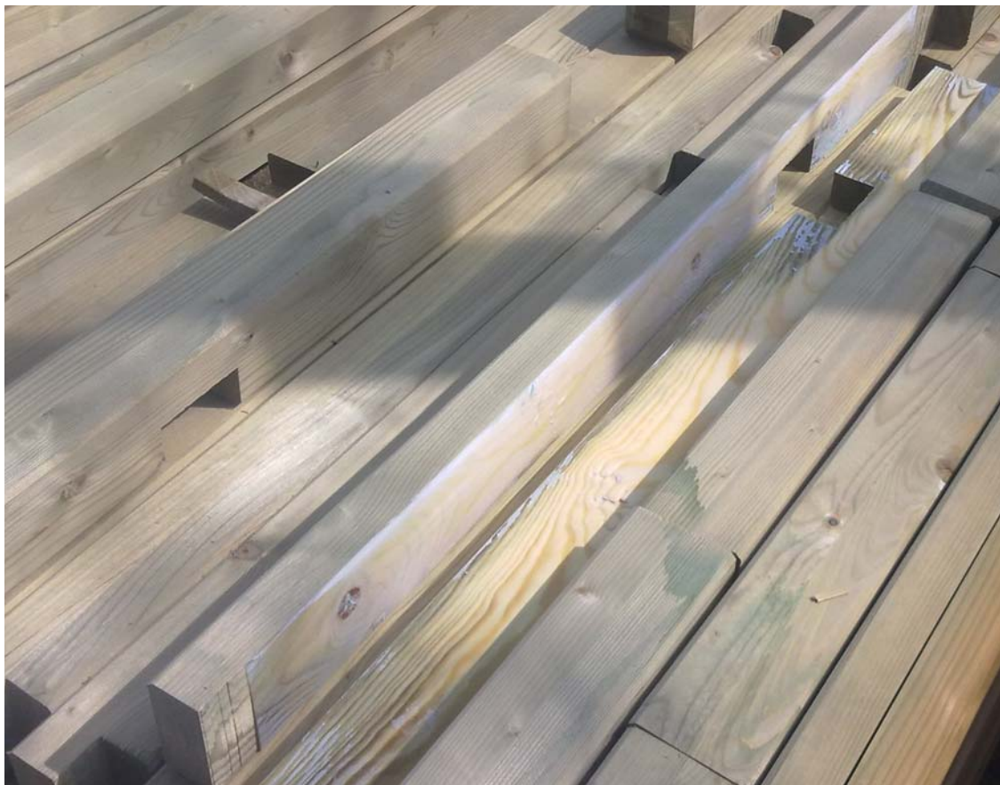
1. ábra A ragasztási síkban a ragasztó kifehéredett, ill. látható a beszivárgott védőszer
