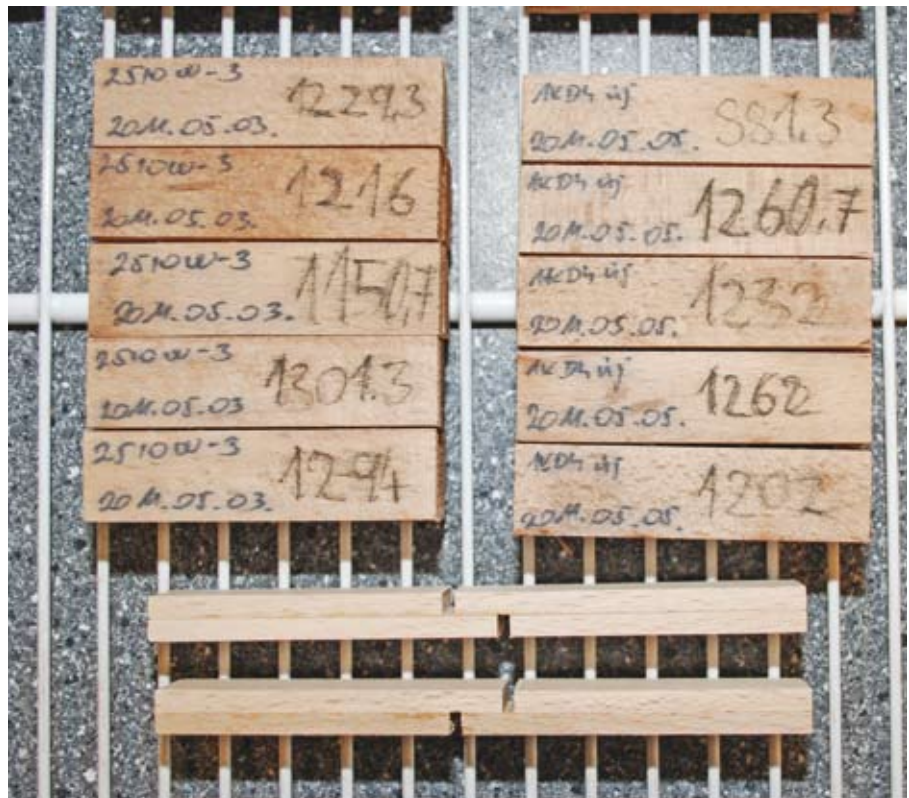
A gyártásra kerülő és az elkészült ragasztókat ellenőrzik a Szolvegy Kft.-nél szabvány szerint, meghatározott gyakorisággal, szabványos bűk próbatesteken
